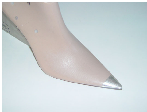
Figura 61 - Fôrma com bico de alumínio
