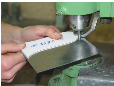
Figura 39 - Recorte da chapa metálica
