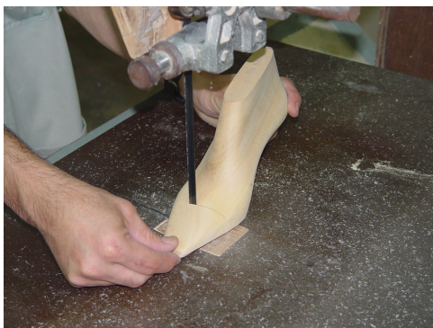
Figura 24 - Corte da fôrma base na serra
