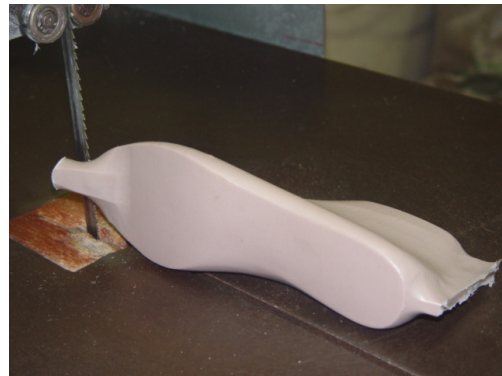
Figura 32 - Corte do bico na serra
