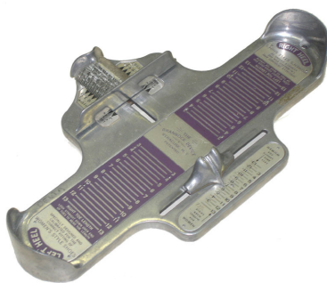
Figura 20 - Aparelho de medição Brannock
