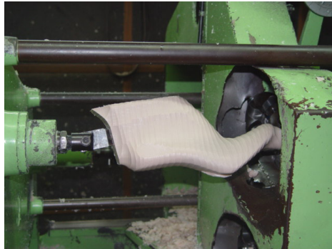
Figura 27 - Pré-torneamento da fôrma
