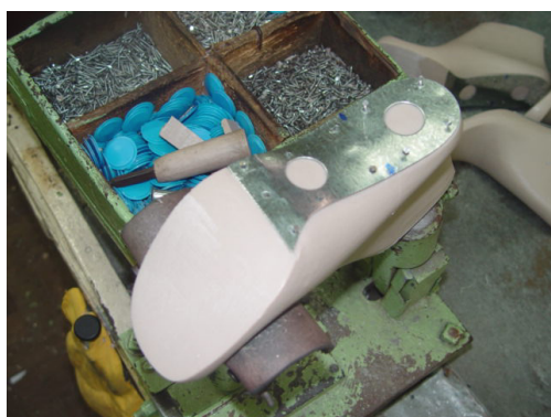
Figura 42 - Fixação da chapa metálica
