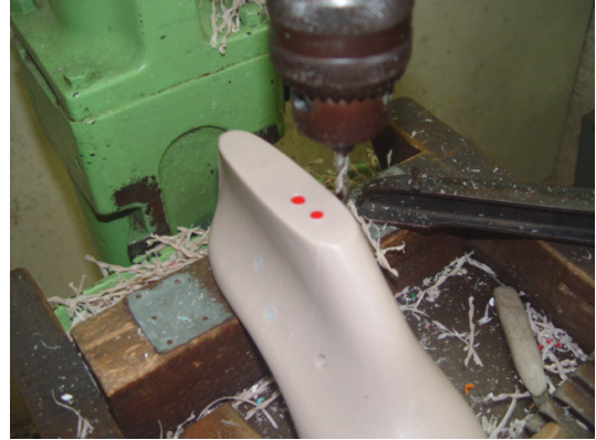
Figura 36 - Colocação de 2 pinos de cor
