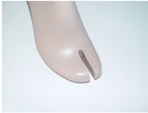
Figura 60 - Fôrma com corte no bico
