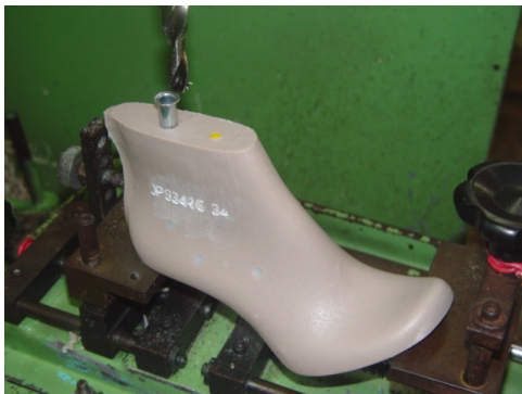
Figura 37 - Colocação manual do tubo metálico
