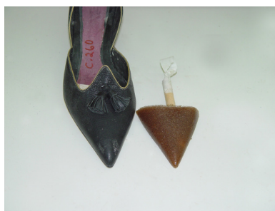
Figura 21 - Desenvolvimento do bico a partir de um calçado pronto
