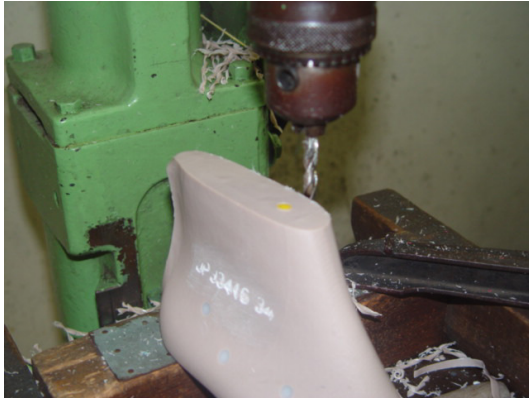
Figura 35 - Colocação de 1 pino de cor
