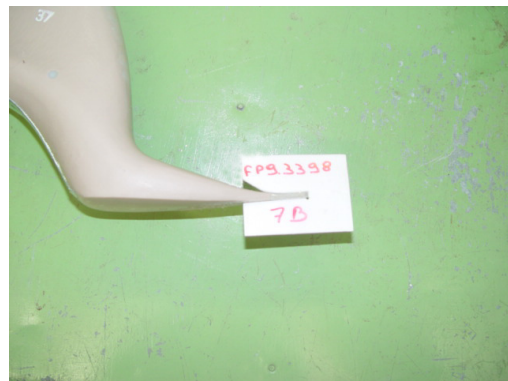
Figura 34 - Aferição do bico com perfil
