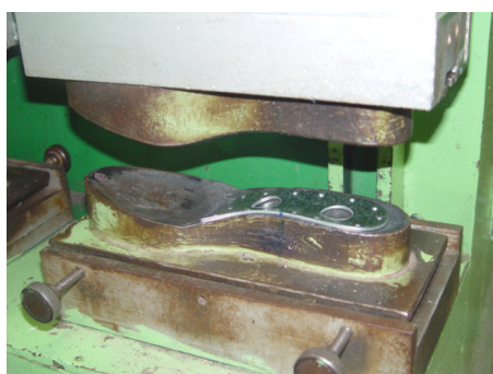
Figura 41 - Conformação da chapa metálica
