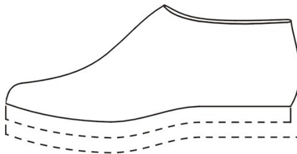
Figura 15 - Diferença entre comprimento da palmilha e comprimento da fôrma
