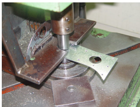
Figura 40 - Perfuração da chapa metálica
