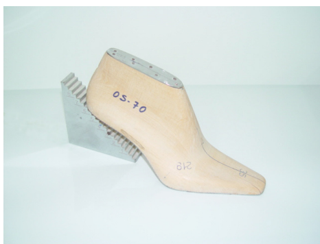
Figura 22 - Definição da altura de salto
