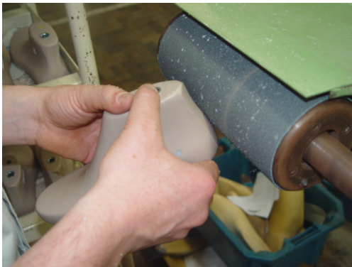
Figura 33 - Ajuste do calcanhar na lixa
