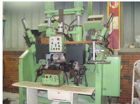
Figura 38 - Máquina p/ perfuração e colocação automática do tubo metálico
